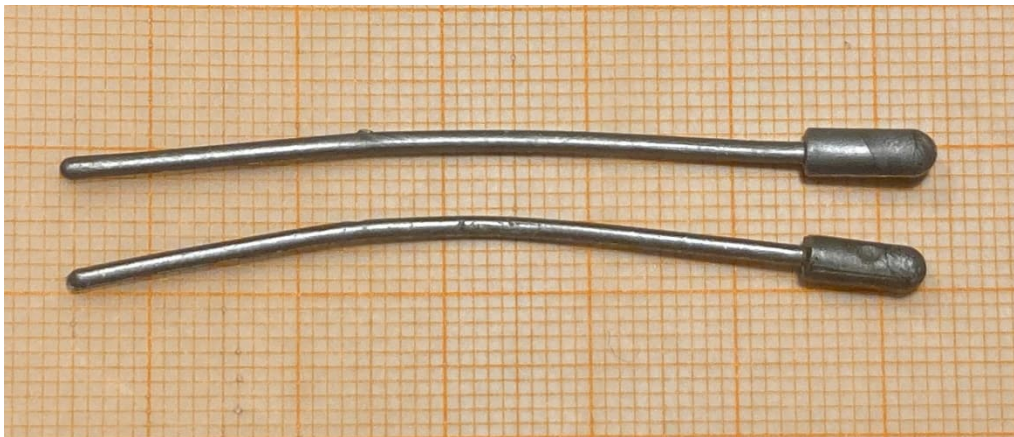
Abb. 13.08 Vergleich der Ladestöcke der 1.ten Version (oben) und 2.ten Version (unten)
