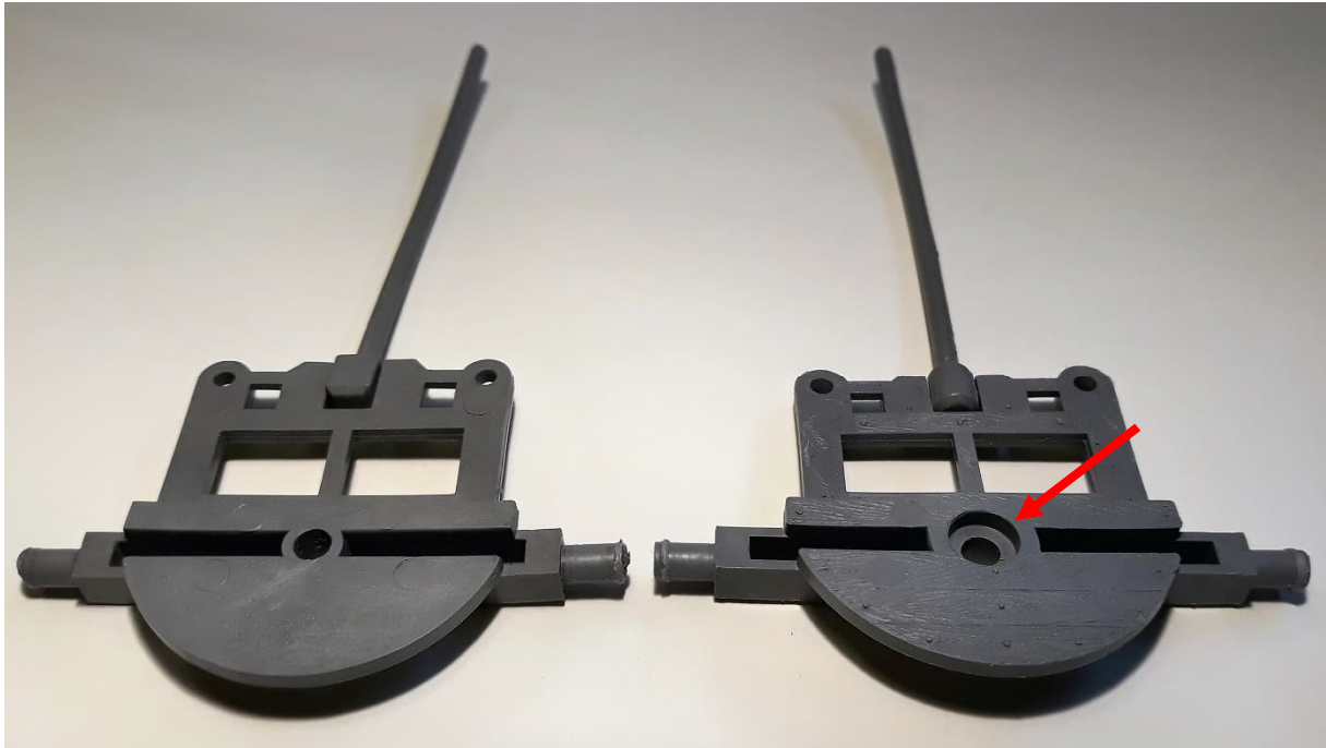
Abb. 04.03 Vorderachse der 1.ten (links) und 2.ten Version (rechts) im direkten Vergleich von der Oberseite
