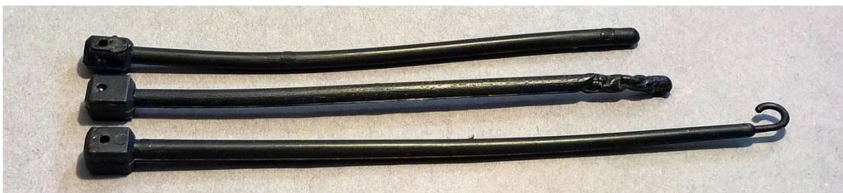
Abb. 12.02 Deichsel der Overland Stagecoach (unten) im Vergleich mit Deichseln der 1.ten (Mitte) und 2. ten Version (oben)
