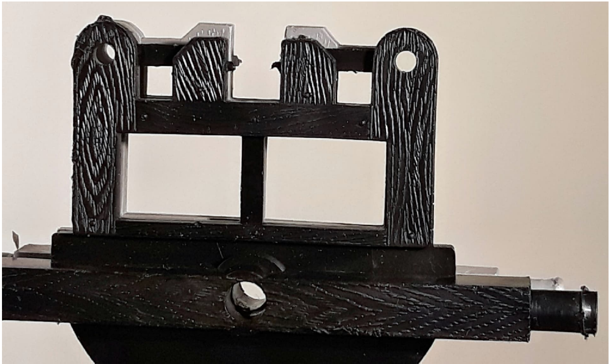
Abb. 04.07 Vorderachse der 1.ten (hinten (grau)) und 2.ten (vorne (schwarz)) Version im direkten Vergleich von der Seite
