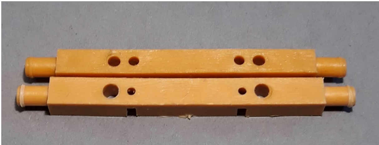
Abb. 02.08 Hinterachse der 1.ten (oben) und 2.ten (unten) Version im direkten Vergleich von der Unterseite
