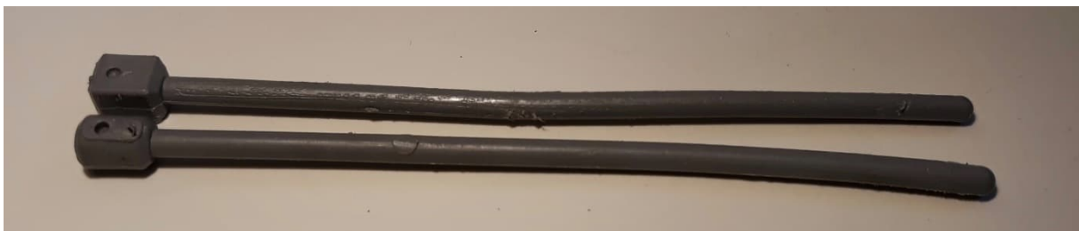
Abb. 04.08 Deichsel der 1.ten (oben) und 2.ten Version (unten) im direkten Vergleich von der Seite
