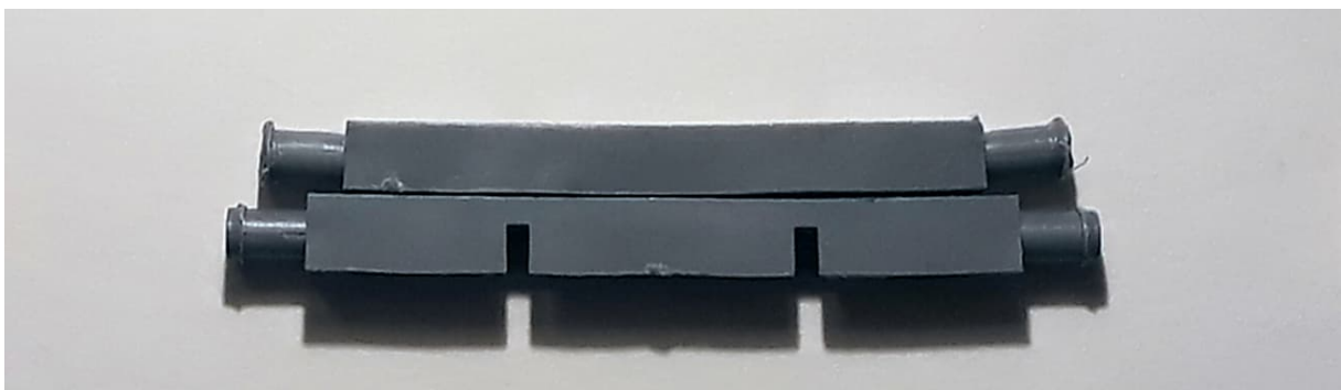
Abb. 04.02 Hinterachse der 1.ten (oben) und 2.ten (unten) Version im direkten Vergleich von der Seite
